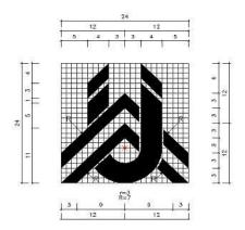
2. Die zusätzlichen Angaben nach Pkt. I sind unmittelbar unterhalb des Bildzeichens in der im Pkt. I angegebenen Reihenfolge anzubringen und voneinander deutlich sichtbar zu trennen, sodass das Einbauzeichen nachstehender Abbildung entspricht, wobei die Breite der Bereiche für die zusätzlichen Angaben jener des Bildzeichens entsprechen muss.
